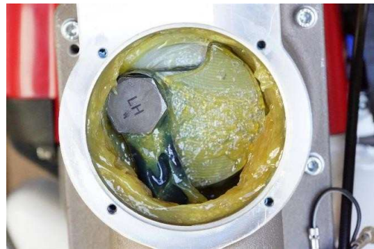
Figura 2 Area del manovellismo con sufficiente grasso. Il colore è giallo prima dell'uso come sopra, e tenderà a marrone con l'età e l'uso.
